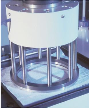
静水圧下においてファブリックに対する水の浸透性を測定する試験方法。サンプルの表面において、3つ目の水滴が現れた点をエンドポイントとして測定します。高い値ほど良い。
