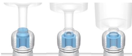
セフィオフローは何も差し込まれていない状態ではしっかりと閉じられていますが、弁のスリットにシリンジなどを挿入すると、弁が押し開かれ、輸液ルートと内部連通できます。
