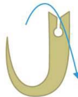
弾機針の構造 矢印のように糸を通す。
